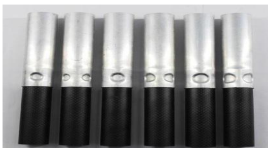
方式二：磁脉冲压/焊混合连接
